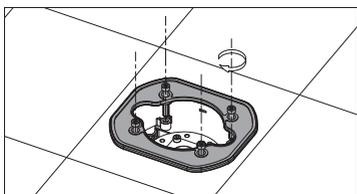
Закрепите водонепроницаемую пластину.
