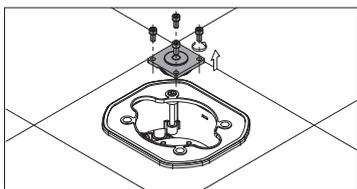
Открутите винты, извлеките пластину с датчиком уровня.
